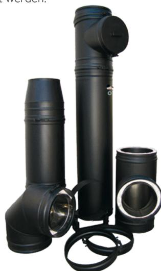
Das PERMETER-Innenrohr ist aus Edelstahl mit der Werkstoff-Nr. 1.4521 gefertigt. Der Außenmantel besteht aus pulverbeschichtetem Stahl und übernimmt die statischen Lasten. Der Zwischenraum ist mit einer 25 mm (bzw. alternativ 50 mm) dicken, speziellen „Super-Wool“ gefüllt.
