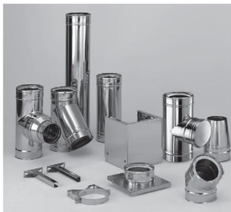
Das **ICS**-Innenrohr ist aus Edelstahl mit der Werkstoff-Nr. 1.4404 gefertigt. Der Außenmantel besteht aus der Werkstoff-Nr. 1.4301 mit hochglänzender Oberfläche und übernimmt die statischen Lasten. Der Zwischenraum ist mit einer 25 mm (bzw. alternativ 50 mm) dicken, speziellen Mineralfaser-Wärmedämmung gefüllt.
