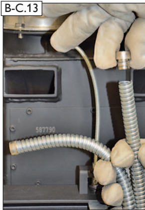
Zum Schutz vor Beschädigungen beim „Einfädeln“ des Druckmessschlauches bzw. des Temperaturfühlers, Endkappen in beiden Enden des Metallschutzschlauches einschrauben.
