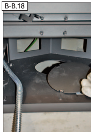
B-B.18 Revisionsdeckel im Geräteboden öffnen.
