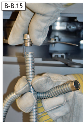
Zum Schutz vor Beschädigungen beim „Einfädeln“ des Druckmessschlauches bzw. des Temperaturfühlers, Endkappen in beiden Enden des Metallschutzschlauches einschrauben.
