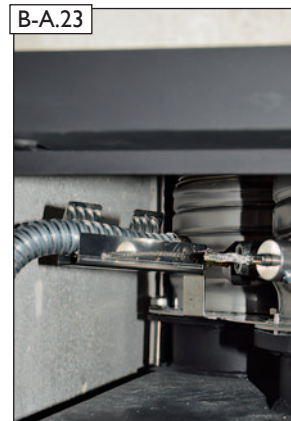
B-A.23 Metallschutzschlauch vollständig über das Messingröhrchen bis zum Verbindungselement aufschieben.
