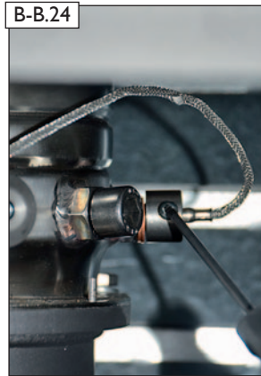
B-B.24 Temperaturfühler vollständig in die Öffnung des Verbindungselementes einstecken und mit der Fixierschraube sichern.
