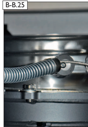
B-B.25 Metallschutzschlauch vollständig über das Messingröhrchen bis zum Verbindungselement aufschieben und ...
