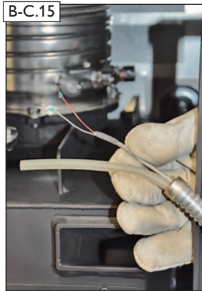
Druckmessschlauch und Temperaturfühler in Metallschutzschlauch einfädeln.
