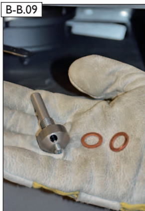
Verbindungselement für Druckmessschlauch und ggf. notwendige Kupferringe zur richtigen Positionierung der Fixierschraube des Verbindungselementes ...
