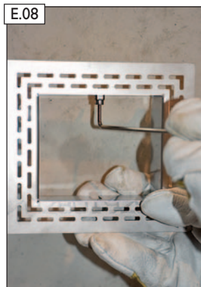
Bei Teleskopeinstellung 0-15 mm müssen die beiden Aufnahmenasen an der Displayblende entfernt werden. Die Displayeinheit rastet bei 0-15 mm in den Aufnahmenasen des LEDA LUC Kunststoffgehäuses ein.
