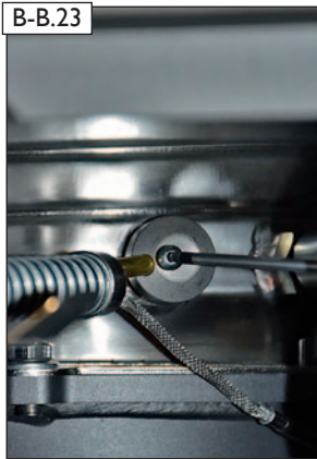
B-B.23 ... in die Öffnung des Verbindungselementes einstecken und mit der Fixierschraube sichern.
