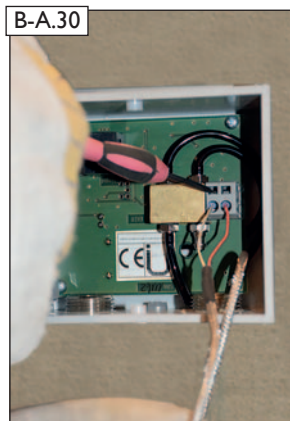
B-A.30 Temperaturfühler in der Bedien- und Messeinheit gem. Schaltplan verklemmen.
