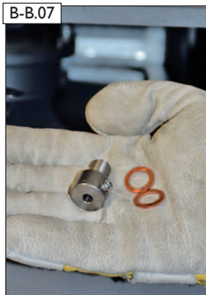
Verbindungselement für Temperaturfühler und ggf. notwendige Kupferringe zur richtigen Positionierung der Fixierschraube des Verbindungselementes ...
