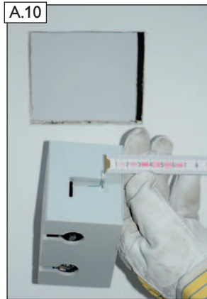
Die Halteklammer der LEDA LUC Bedien- und Messeinheit benötigt mind. 15mm starken Aufbau. Ggf. muss hier bauseits, rückseitig in der Montageöffnung, unterfüttert werden.
