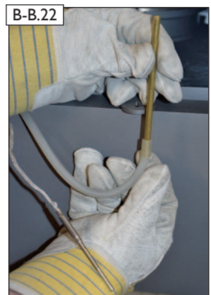
B-B.22 Druckmessschlauch ca. 2 cm auf das Messingröhrchen aufschieben und ...
