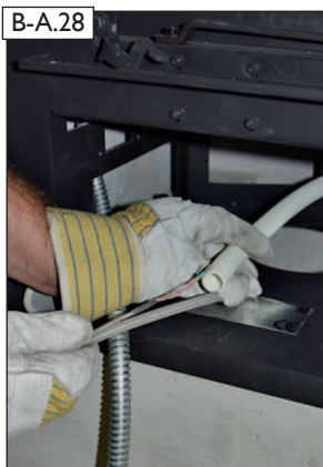
B-A.28 Druckmessschlauch und Temperaturfühler einführen und ...
