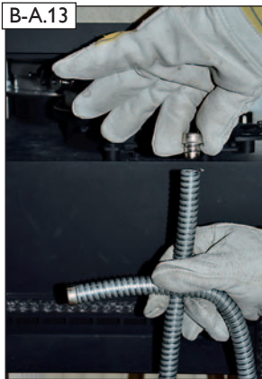
Zum Schutz vor Beschädigungen beim „Einfädeln“ des Druckmessschlauches bzw. des Temperaturfühlers, Endkappen in beiden Enden des Metallschutzschlauches einschrauben.
