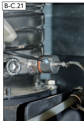
B-C.21 Temperaturfühler vollständig in die Öffnung des Verbindungselementes einstecken und mit der Fixierschraube sichern.
