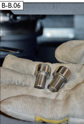
Die beiden Edelstahlverschraubungen M12 werden zur weiteren Montage nicht mehr benötigt.
