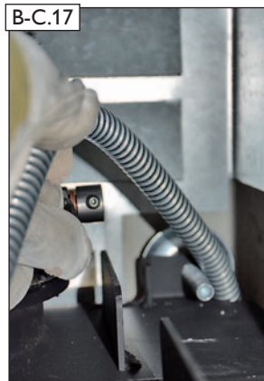
B-C.17 Metallschutzschlauch in der hinteren Ecke, zwischen Strahlungsblech und Brennkammer nach unten in den Bereich der Konvektionsluftöffnung der Brennkammer führen. Druckmessschlauch und Temperaturfühler vollständig aus dem Metallschutzrohr durchfädeln. ACHTUNG! Beschädigungen sind dabei zu vermeiden!
